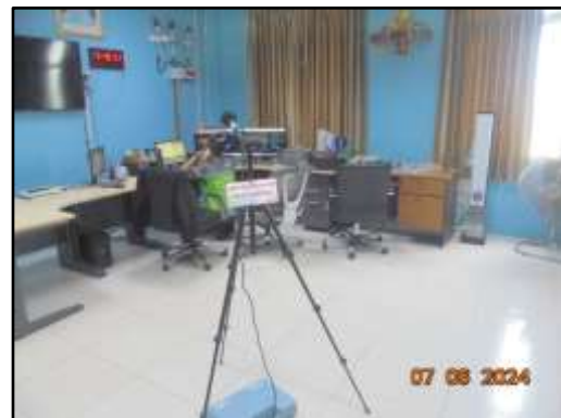
ภาพที่ 3.44 การตรวจวัดระดับเสียงบริเวณอาคาร WHG 6 Control Room
