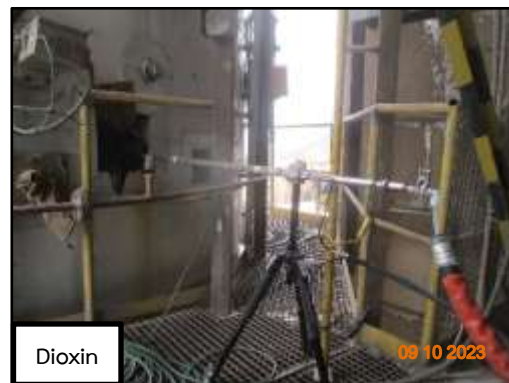
ภาพที่ 3.17 การตรวจวัดคุณภาพอากาศจากปล่องหม้อเผา 5
