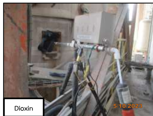
ภาพที่ 3.15 การตรวจวัดคุณภาพอากาศจากปล่องหม้อเผา 3
